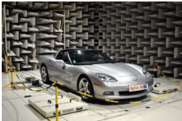
Chambre semi-anéchoïque du CRITT M2A
